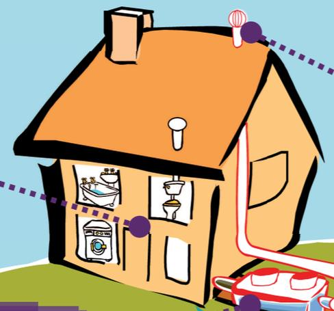
La **ventilation secondaire** assure l'évacuation des gaz toxiques et corrosifs produits naturellement dans le prétraitement : elle doit être montée sur le toit et équipée d'un **extracteur**.
